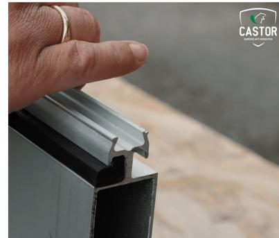
5. Couper le surplus du joint au cutter. Ne pas hésiter à laisser une sur longueur de 5mm de part et d'autre.
