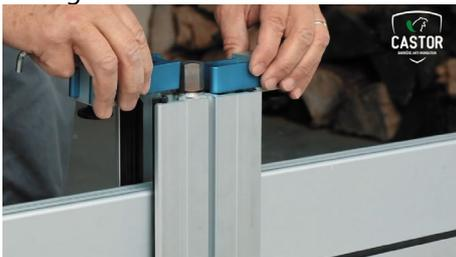
4. Descendre le vérin serreur jusqu'à ce qu'il soit en contact avec la planche.
